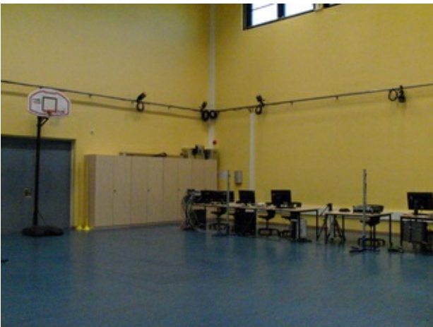
Testraum 1: Motion Capturing in Verbindung mit Dynamometrie und Elektromyographie für die Ganganalyse und viele sportliche Bewegungen
